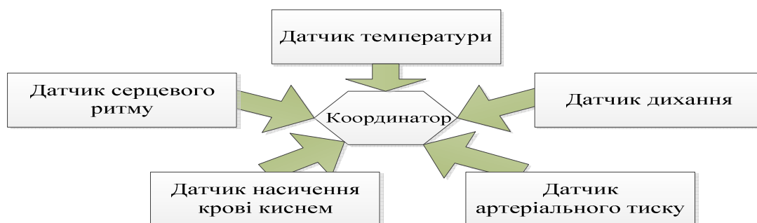
Рисунок 2 – Структурна схема прийому даних DAS
